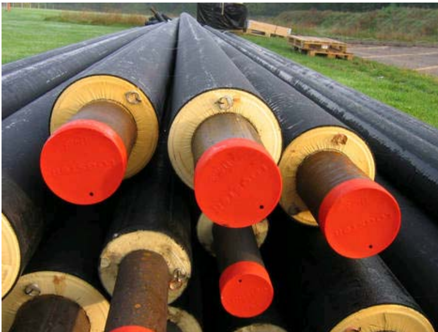
Figuur 26: Geïsoleerde buizen voor een warmtenet
